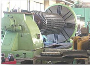
**Figura 1.14:** Turbina Ossberger acoplada a un generador
