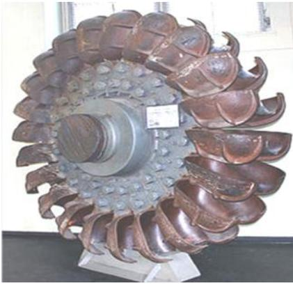
**Figura 1.12:** Rodete de una Turbina Pelton Fuente:
