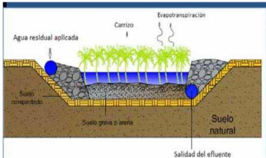
**Figura 1.5. Esquema de trayectoria de un humedal de flujo superficial**
