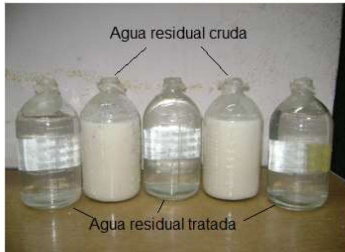
Figura 21. Estudio de tratabilidad del residual de la fábrica de pintura (Fuente: Ramírez y Argota, 2019)
