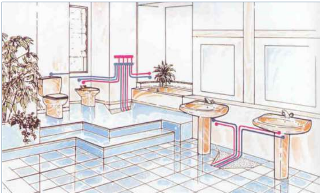
Figura 1.1. Instalaciones hidrosanitarias. (Fuente: Biblioteca Atrium de la construcción, Instalaciones de una vivienda)
