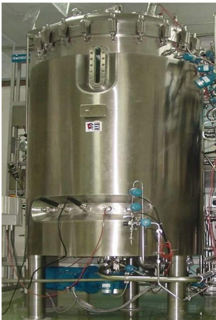
Figura. 3 Biorreactor de tanque agitado de 1500 L empleado en las producciones del Centro de Inmunología Molecular.
