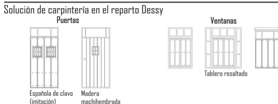
Figura 2.26_ Tipo de carpintería empleada en la vivienda individual Art Decó del reparto Dessy
