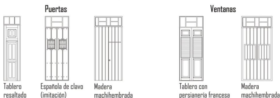
Figura 2.15_Tipo de carpintería empleada en la vivienda individual Art Decó del reparto Flores
