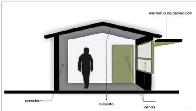
**Figura 1.4** Componentes de la envolvente (paredes, cubierta, vanos y elementos de protección)
