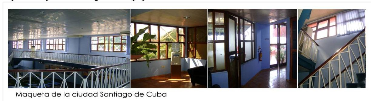
**Fig. 1.10** Interiores de la sala de posición. Nótese el falso techo de grosfillex (material plástico - PVC) y la galería superior de ventanas vidriadas al Sur con el considerable aporte térmico.
