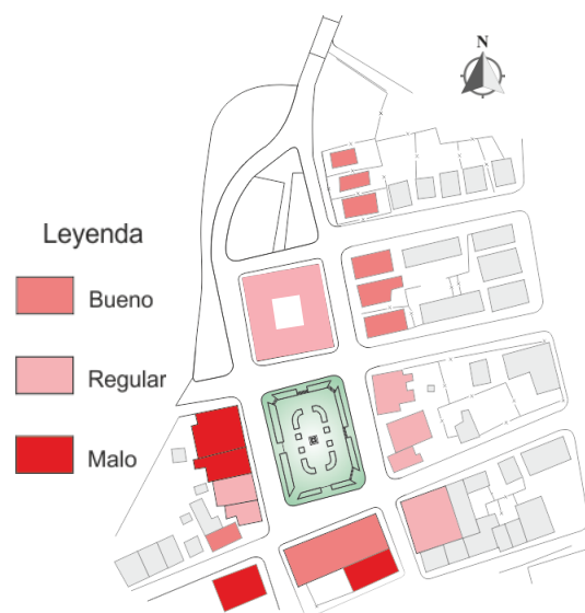
Figura 4. Estado de las edificaciones.
