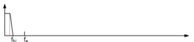
**Figura 1.28.** Respuesta a frecuencia de un filtro antialiasing de un CAD de frecuencia de Nyquist.
