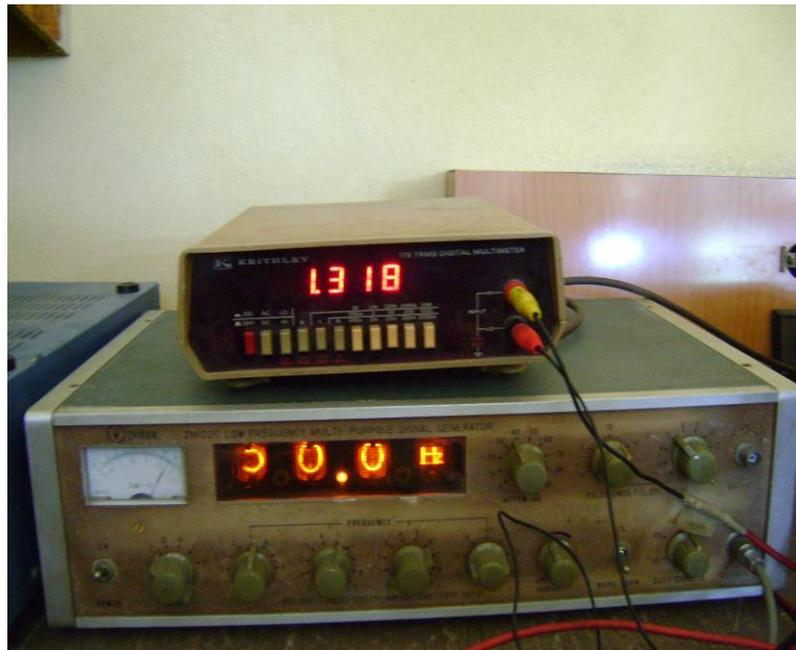
Figura 2.47. En la figura, la salida del controlador con una frecuencia de 50 Hz a la entrada.
