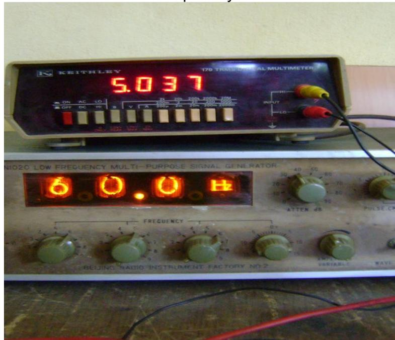
Figura 2.30. En la figura, la señal de entrada del conversor de frecuencia a voltaje y su respectiva señal de salida proporcional a la frecuencia de entrada.
