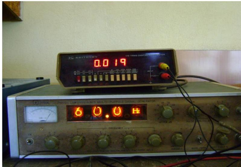
Figura 2.39. En la figura, la señal de salida del circuito restador cuando la frecuencia a la entrada es 60 Hz.
