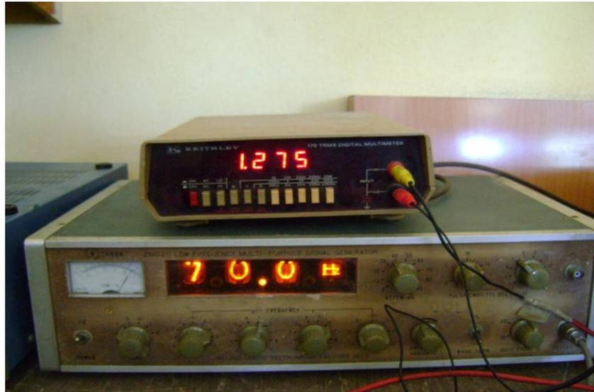
Figura 2.43. En la figura, la señal de salida del circuito restador cuando la frecuencia a la entrada es 70 Hz.
