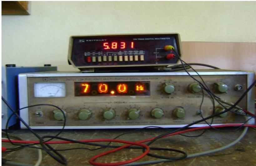
Figura 2.32. En la figura, la señal de salida del conversor para una frecuencia de entrada de 70 Hz.
