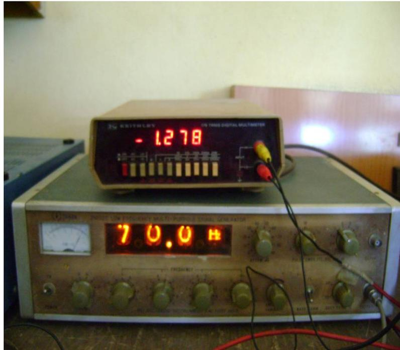
Figura 2.49. En la figura, la señal de salida del controlador para una frecuencia de 70 Hz a la entrada.
