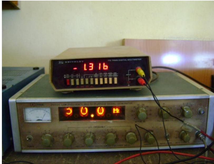
Figura 2.41. En la figura, la señal de salida del circuito restador cuando la frecuencia a la entrada es 50 Hz.
