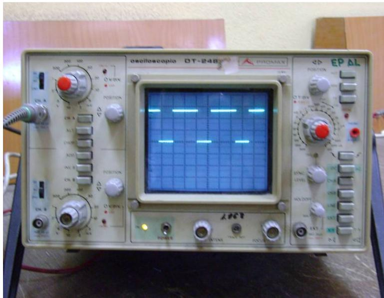
Figura 2.28. En la figura, la señal de salida del CI 555 para 50 Hz de frecuencia a la entrada del conversor.
