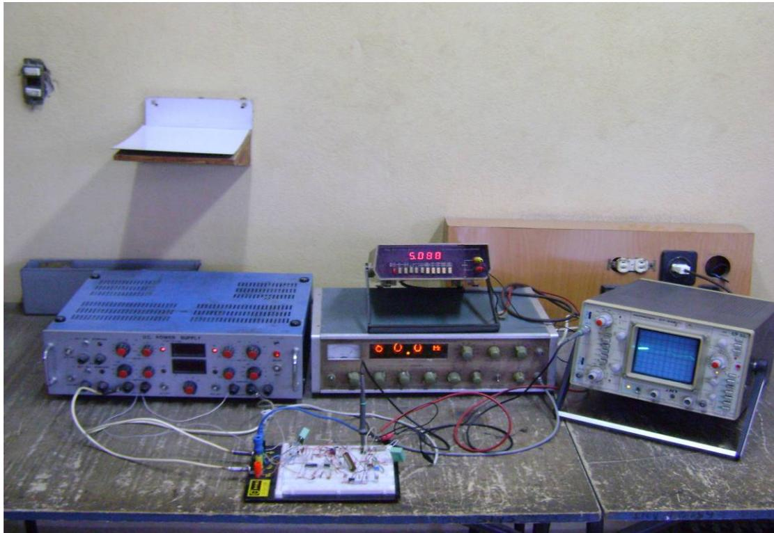
Figura 2.23. En la figura, la mesa de trabajo con todo el equipamiento empleado. A continuación se muestra los resultados obtenidos en el laboratorio:
