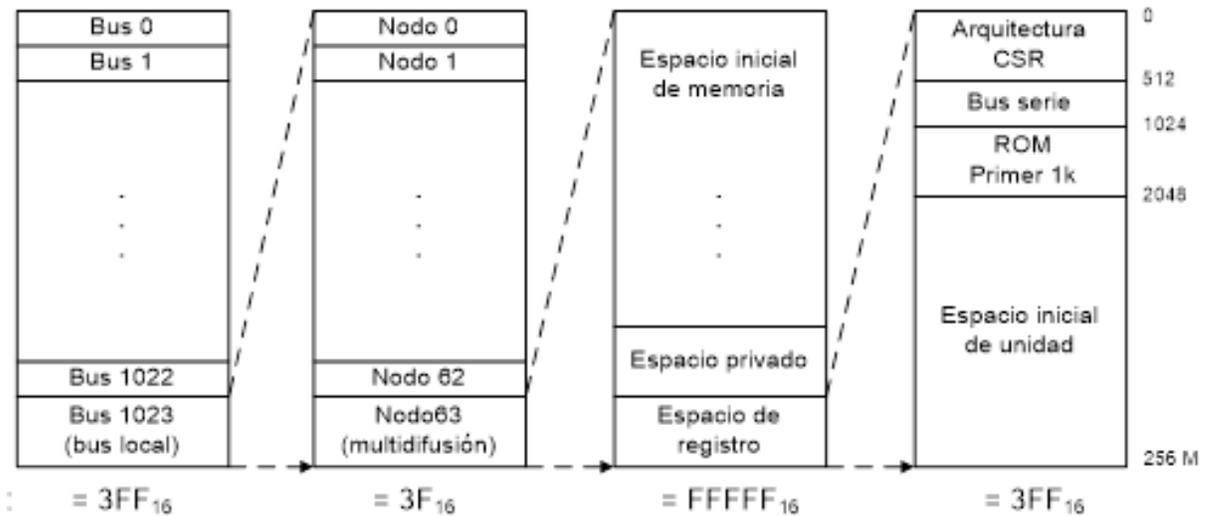
Figura 1.3. Direccionamiento del Bus Serie.
