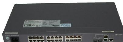
Figura.2.4. LAN switch Quidway Huawei 3328.
