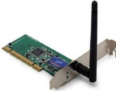
Figura.1.8 Tarjeta PCI.
