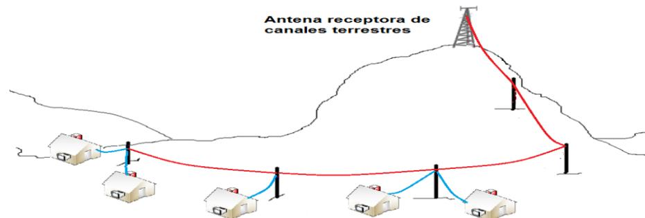
Fig. 1.1. Estructura inicial de los sistemas de televisión por cable (Fuente [1])
