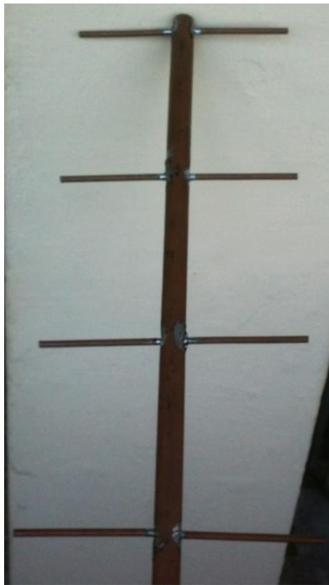
Figura 2.13. Elementos Corregidos y fijados al boom.
