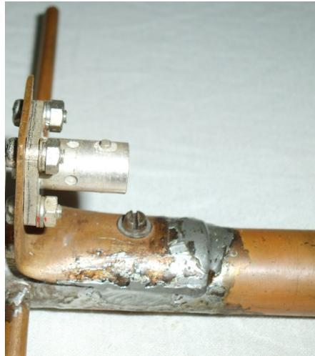
Figura 2.17. Pieza fijada al boom con el conector BNC instalado.
