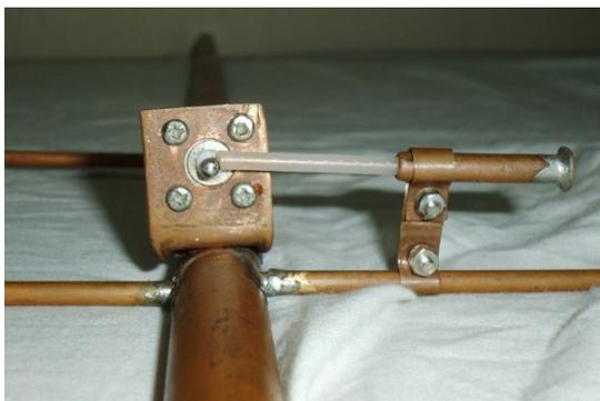
Figura 2.18. Acoplador Gamma vista delantera.
