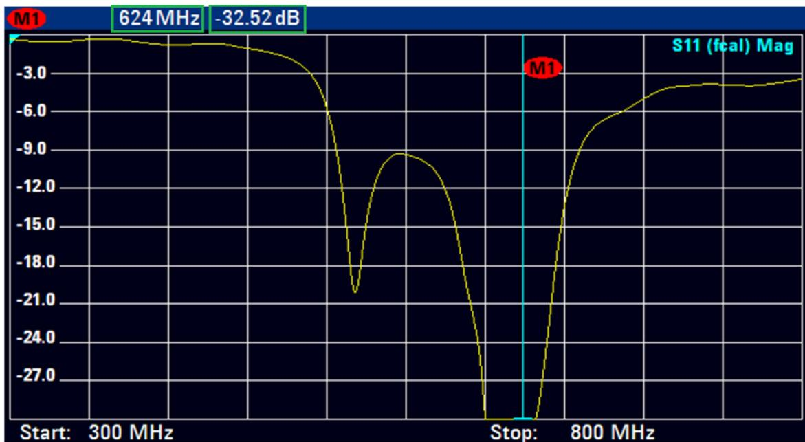
Figura 2.22. Pérdida de retorno medida con el analizador de espectro.
