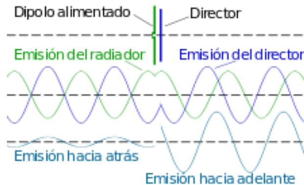
Figura 1.10. Funcionamiento de una antena Uda-Yagi. (Fuente: [2])
