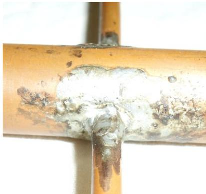
Figura 2.11. Método de soldadura con estaño
