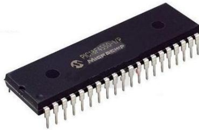
Fig. 1. Microcontrolador PIC18F4550 físico.
