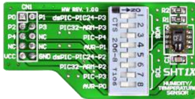
Ilustración Módulo SHT11 expendido por la compañía Mikroelektronika.
