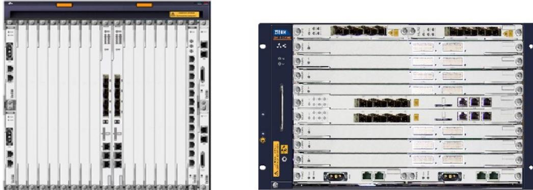
**Figura 3.7.** Vista frontal de los MSAN ZXA10 300M (izquierda) y ZXA10 350M (derecha).
