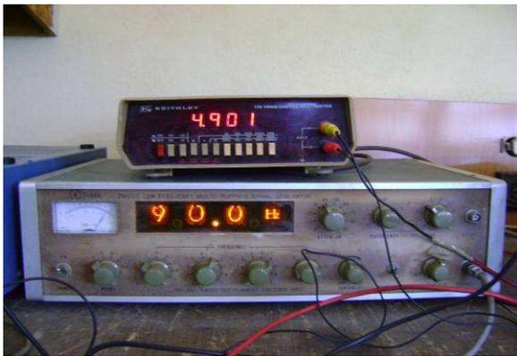
Figura: 2.31 Voltaje de salida del segundo bloque para una frecuencia de 90Hz.
