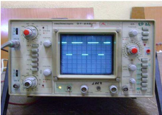
Figura 2.23 Señal de salida del CI NE555 para 75Hz.
