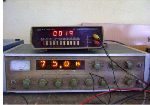
Figura: 2.26 Señal de salida de controlador para una frecuencia de 75Hz.
