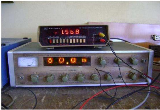
Figura: 2.29 Voltaje de salida del A.O restador del bloque de control del sistema para una frecuencia de 60Hz.
