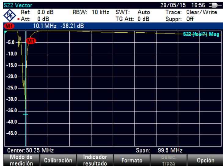
Figura 2.42. Simulación para  $S_{22}$  para el filtro de 10 MHz.
