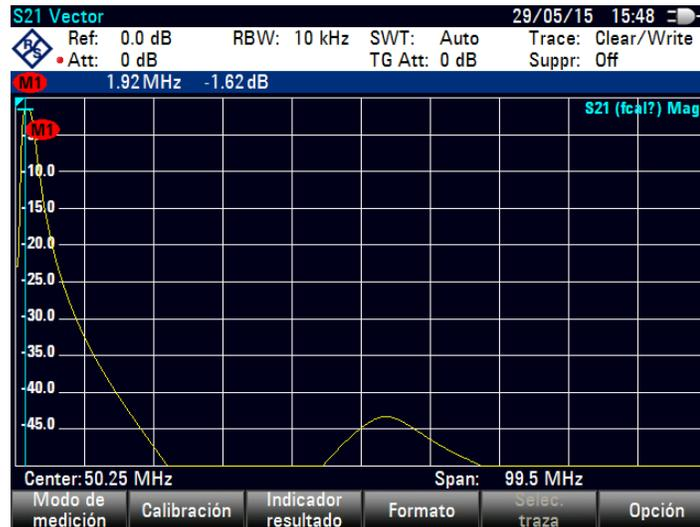
Figura 2.37. Simulación para  $S_{21}$  para el filtro de 1.9MHz.
