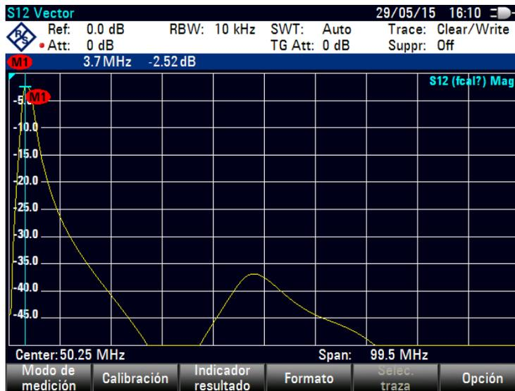
Figura 2.40. Simulación para  $S_{12}$  para el filtro de 3.7MHz.
