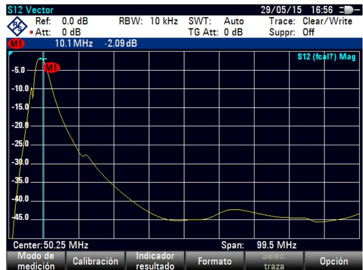
Figura 2.43. Simulación para  $S_{12}$  para el filtro de 10 MHz.
