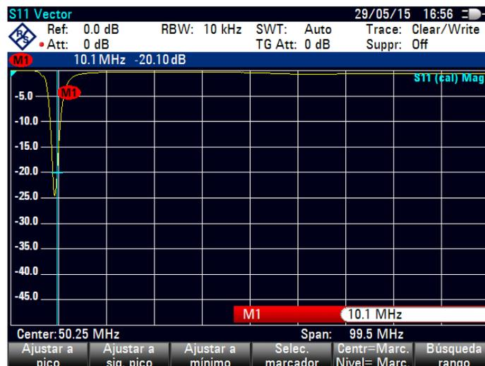
Figura 2.42. Simulación para  $S_{11}$  para el filtro de 10 MHz.
