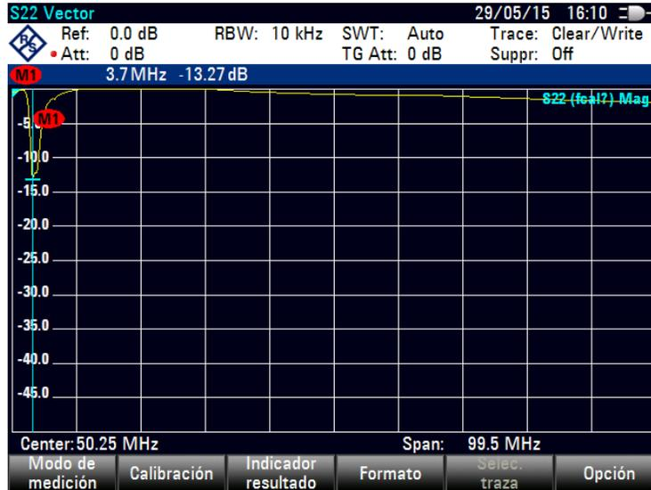
Figura 2.39. Simulación para  $S_{22}$  para el filtro de 3.7MHz.
