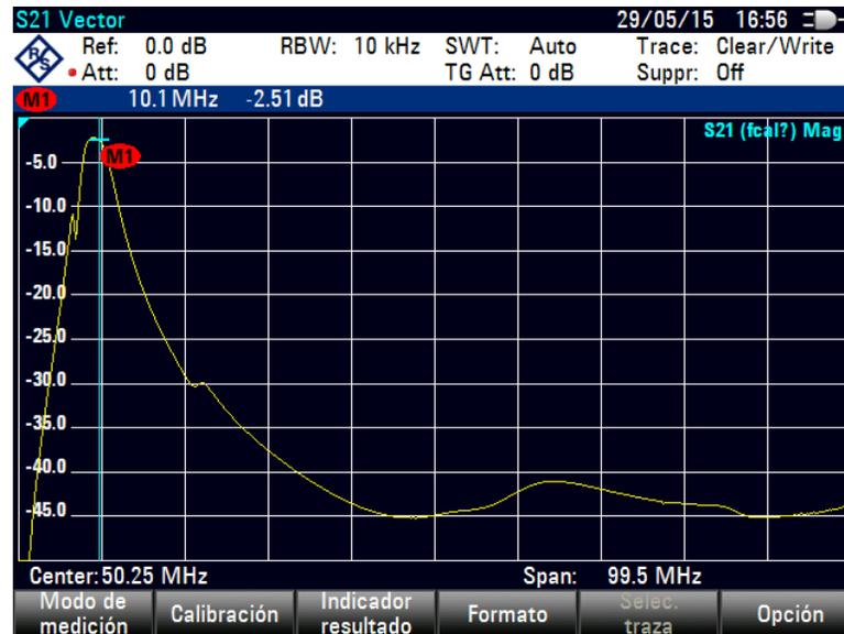
Figura 2.44. Simulación para  $S_{21}$  para el filtro de 10MHz.
