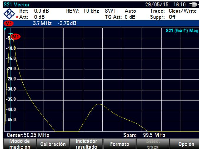
Figura 2.41. Simulación para  $S_{21}$  para el filtro de 3.7 MHz.
