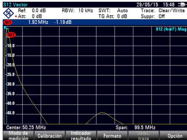
Figura2.36.Simulación para  $S_{12}$  para el filtro de 1.9MHz.
