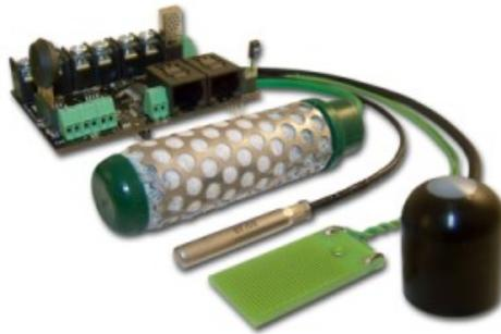
Figura 2.12. Placa de sensores para agricultura de precisión (Fuente: [45]).
