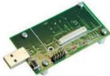
Figura 2.2. Placa programadora MIB520CB (Fuente: [35]).
