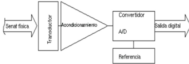
Figura 3.2 Esquema en bloques de un sistema de adquisición de datos.
