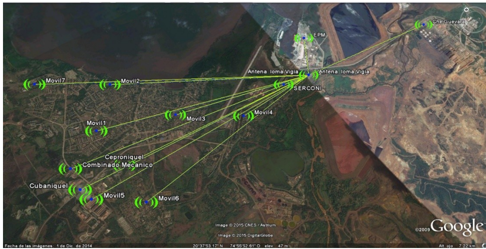
Figura 2.15 Enlaces inalámbricos desde el punto de acceso Loma de la Vigía vistos con Google Earth.
