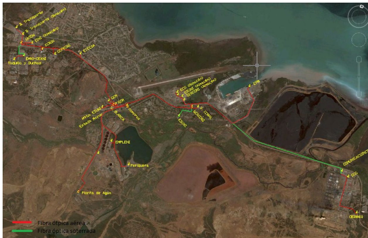
Figura 2.1 Estado actual de la red cableada del grupo.
