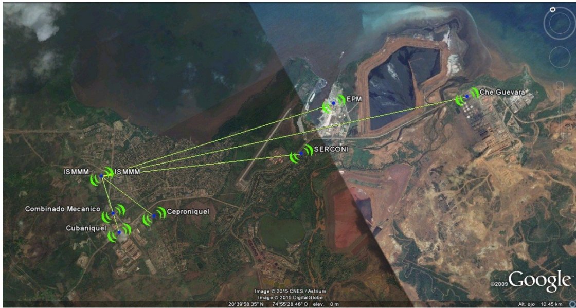
Figura 2.13 Backbone inalámbrico desde el punto de acceso ISMMM visto con Google Earth.
