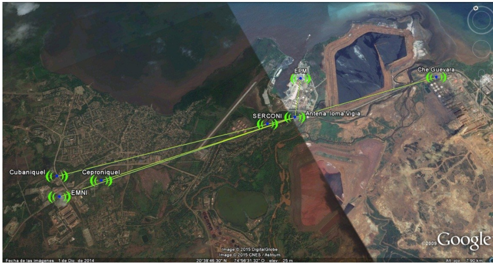
Figura 2.3 Backbone inalámbrico desde el punto de acceso Loma de la Vigía visto con Google Earth.
