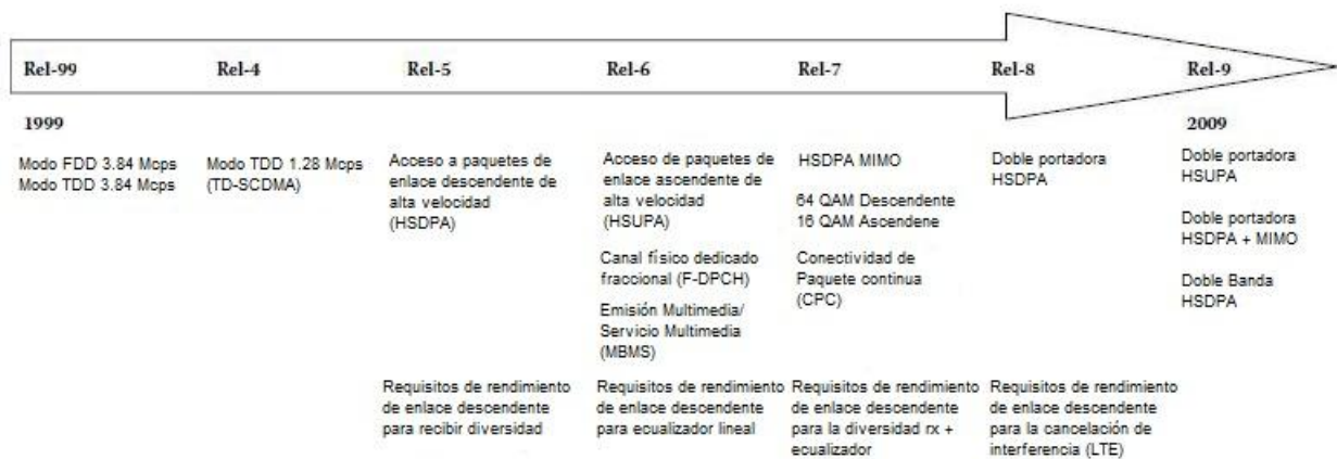
Figura 1.4. Características principales de las Release de UMTS (Fuente: [4])
