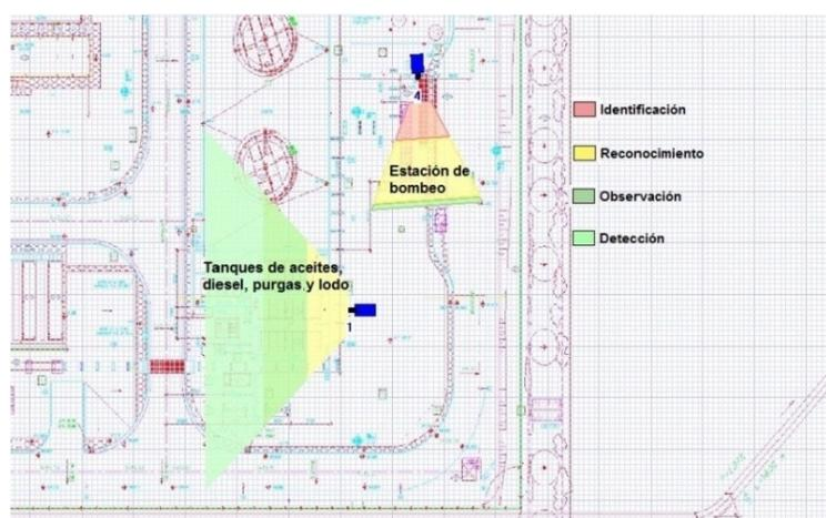
Figura 3.14. Área de visualización de las cámaras C1 y C4.
