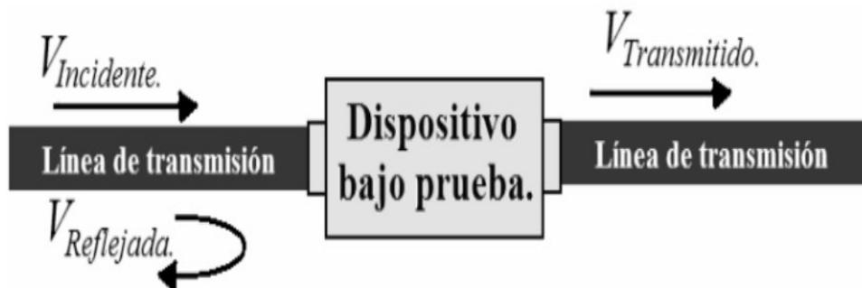
Fig.1.1 Voltaje incidente, reflejado y transmitido.
