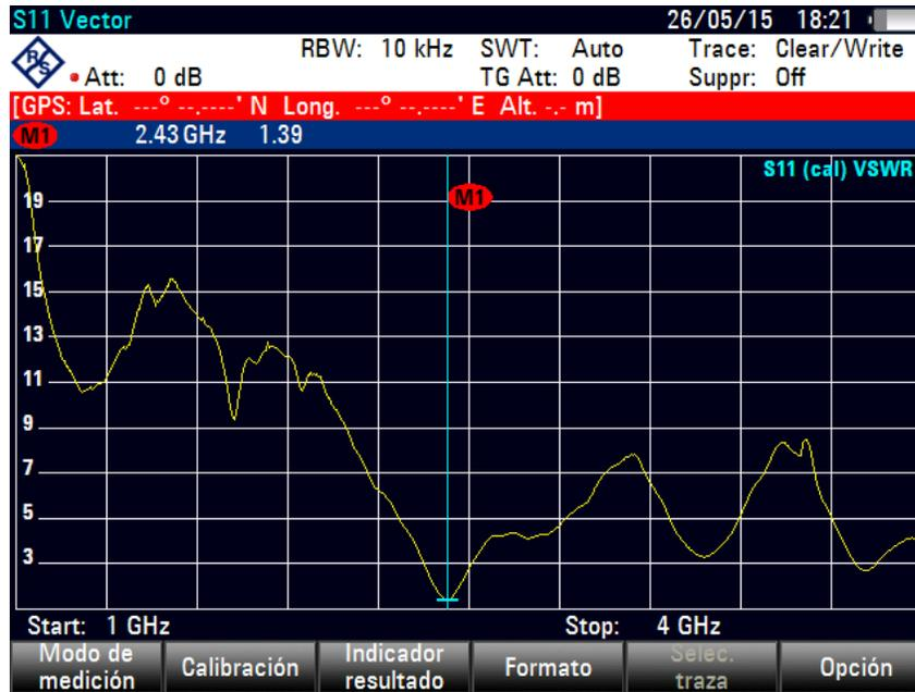
Fig.3.8 Razón de onda estacionaria de la antena construida.
