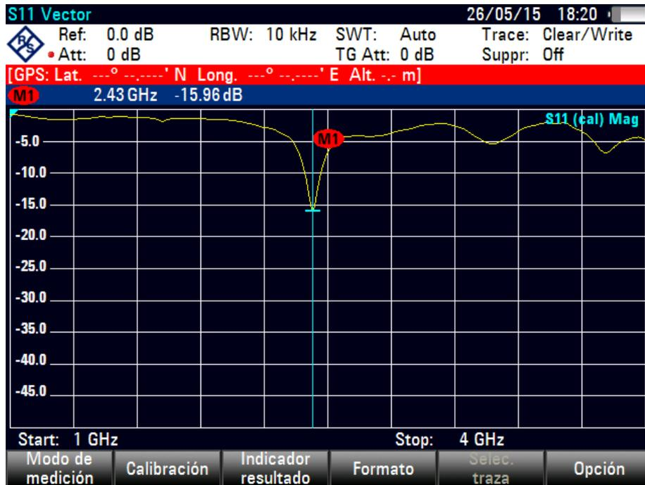
Fig.3.6 Pérdidas de retorno de la antena construida.
