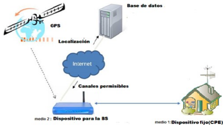
Figura 2.2. Componentes de la red WRAN y su interacción.
