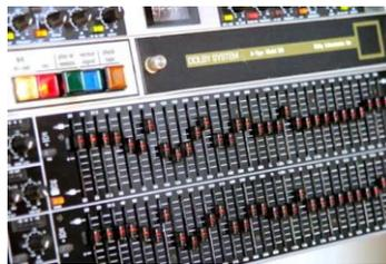
Figura 1.12. Ecualizador gráfico estéreo de 1/3 de octava.[ Fuente: 10]
