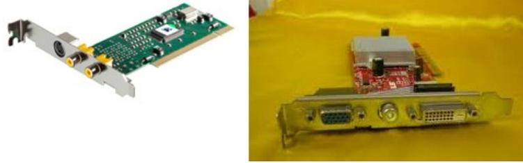
**Figura 3.20.** Tarjetas de video. De izquierda a derecha: Captura: IMAGINGOURCE DFG/SV1 / Salida: ASUS a9250/TD/128M/A. [Fuente: 24]
