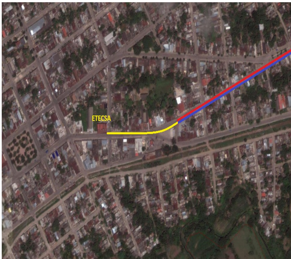
Figura 4. Soterrado y salida aérea de los cables 11 y 14.
