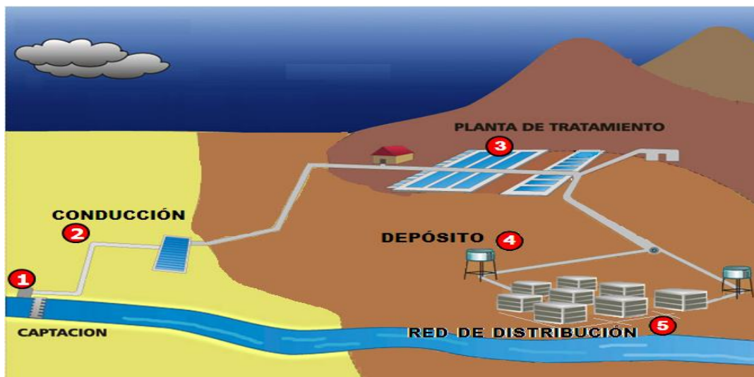
Figura 1.1. Esquema de un sistema de abastecimiento de agua. Fuente: Fair, (2018)
