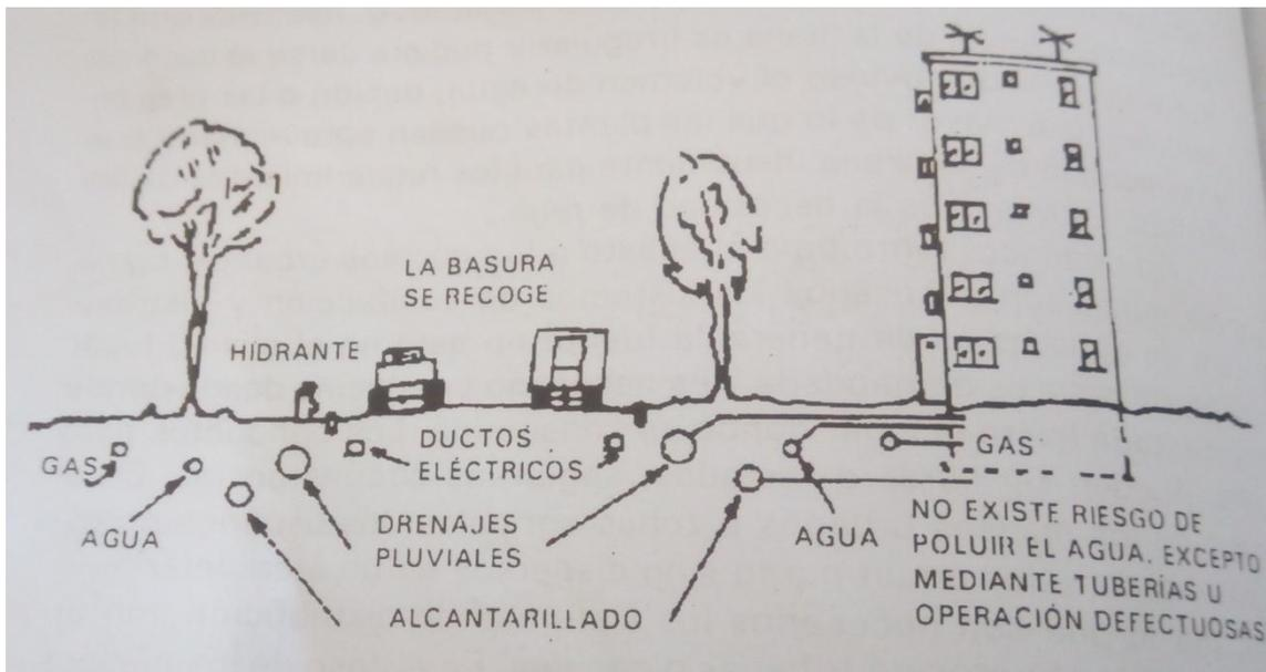
**Figura 5** Sistema de drenaje pluvial. [Fuente. Pérez Monteagudo 2001].
