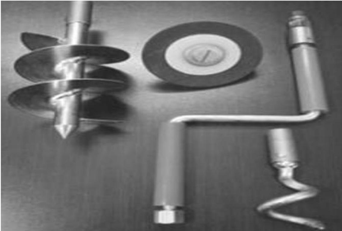
Accesorios para limpieza, usados conectados a varillas de acción mecánica.
