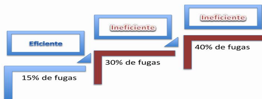
Figura 2.2. Ineficiencia física del sistema de agua. Fuente: Ochoa, (2020).
