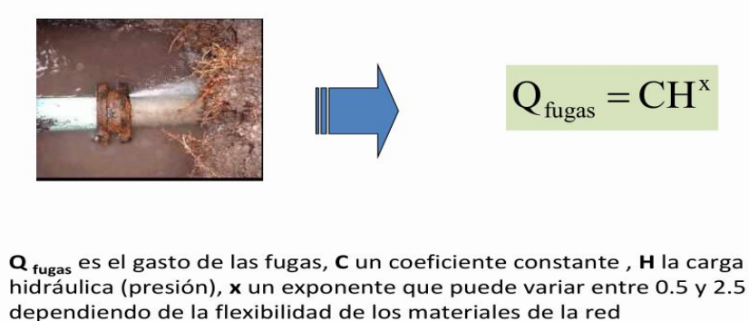
Figura 1.2. Ejemplo de fuga en un sector hidrométrico. Fuente: Ochoa, (2020).
