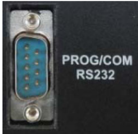
Figura 2.12. Conector externo trasero puerto RS232 de la CPU del EROSPLC-D.
