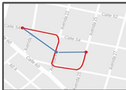
Figura 2.19. Errores típicos al reducir trayectorias. En color rojo la trayectoria real del vehículo en un minuto, en azul la trayectoria aparente (tomando muestras cada 30 segundos).
