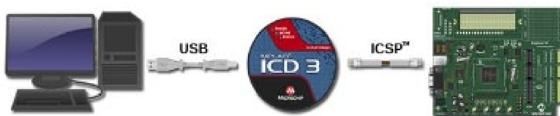
Fig. 2.24 Interfase para la programación de microcontroladores de Microchip.
