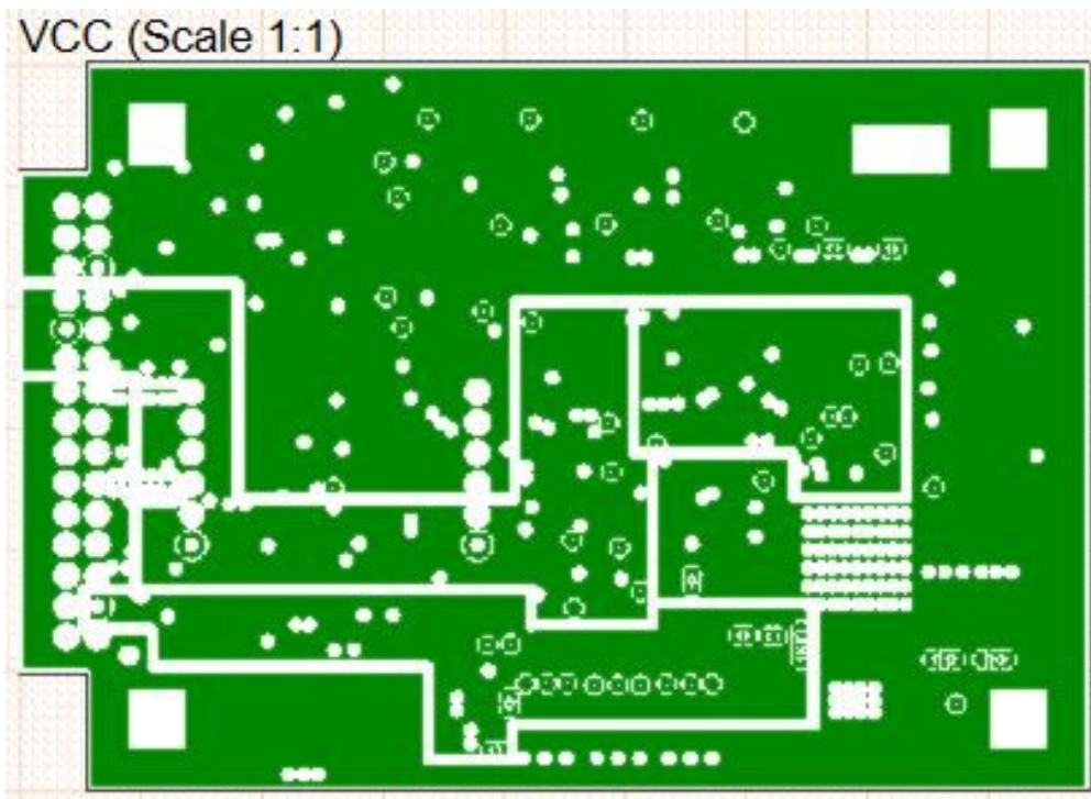
Fig. 3a. Vista de planos internos de la capa "VCC"
