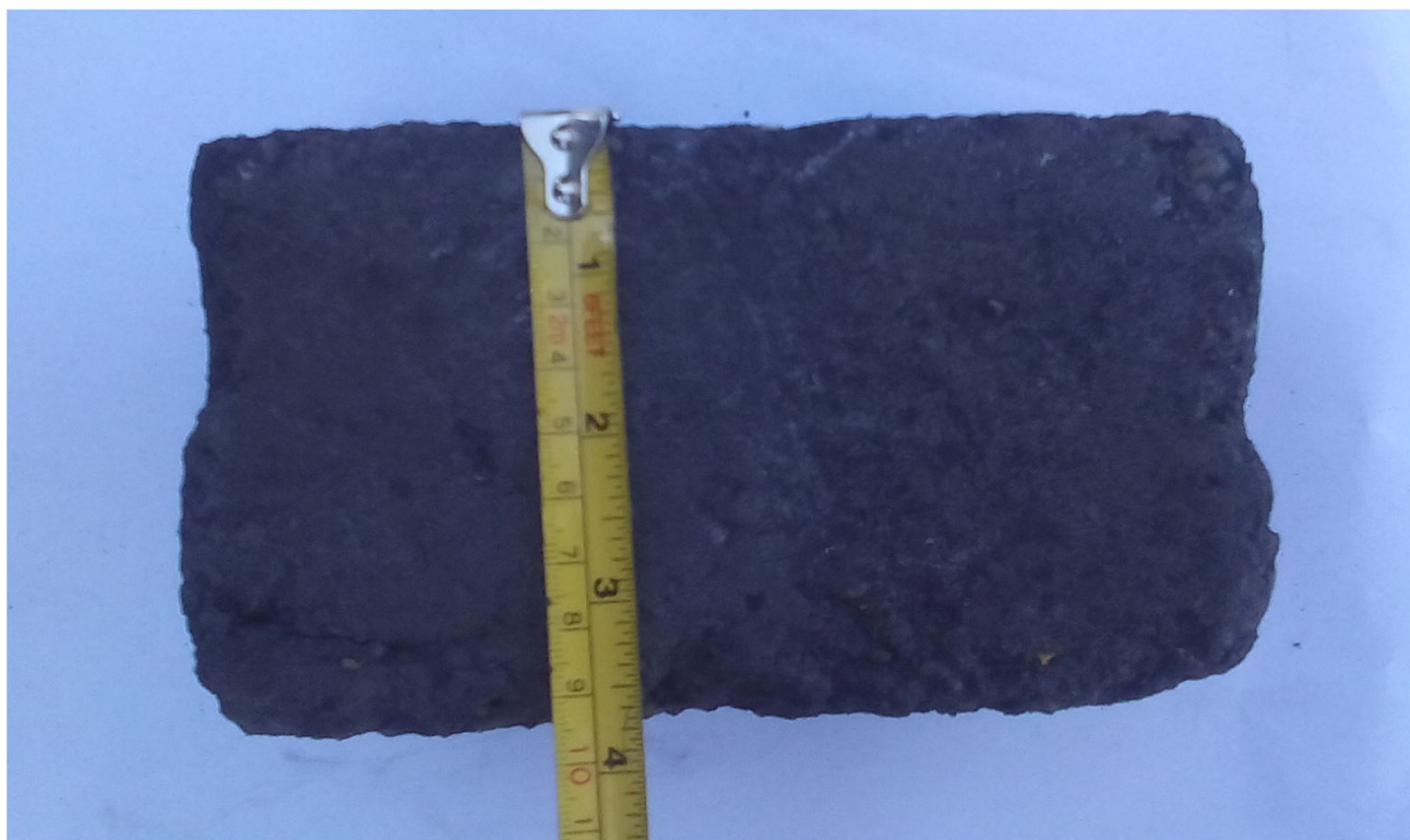
Figura 18: Fotos tomadas a los ladrillos refractarios de la pared del HAE:
