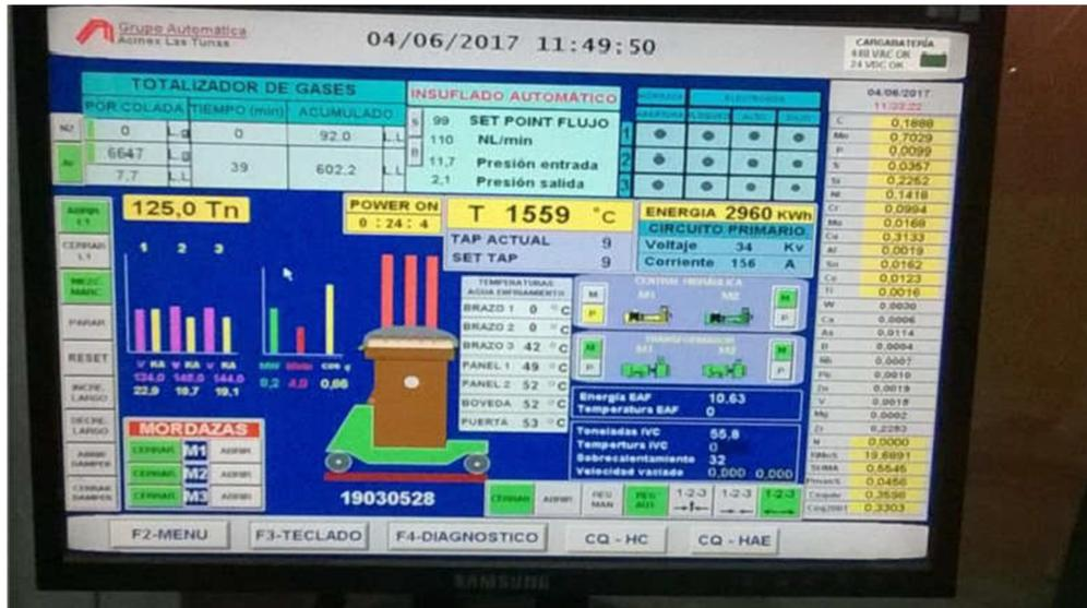
*Figura 1.12. Aplicación Scada Del Proceso En El Horno Cuchara.*
