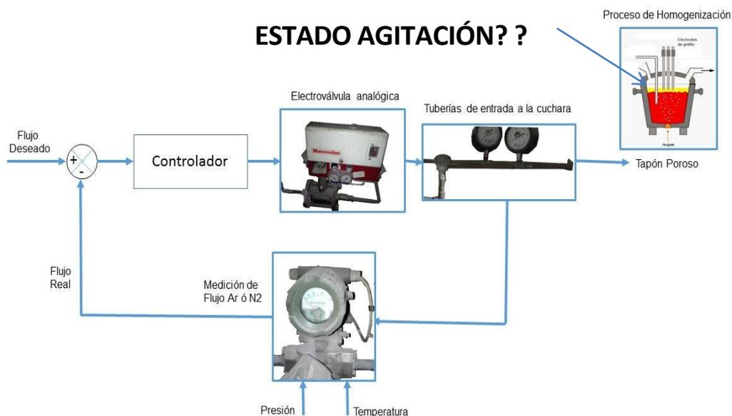
*Figura 1.14. Diagrama En Bloques Del Sistema De Control Del Insuflado De Gas En Horno Cuchara.*
