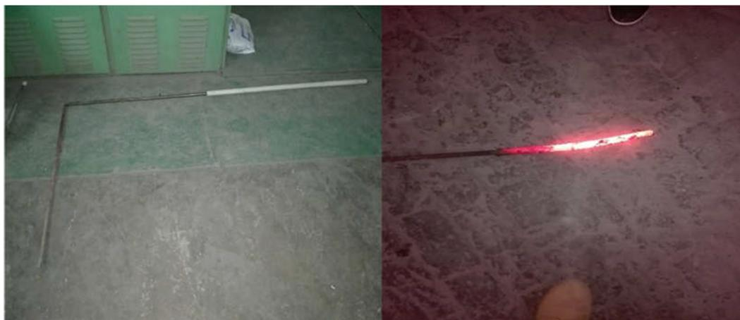
*Figura 2.2. Tubo Preparado Para Medir El Espesor De Escoria.*
