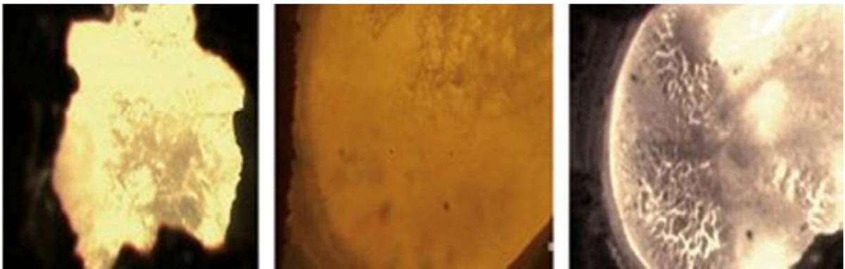
*Figura 1.8. Limitación Del Campo Visual Por Adhesiones De Acero/Escoria, Humo Entre La Cámara Y La Superficie Del Baño Y Agitado Sin Apertura Del Ojo*
