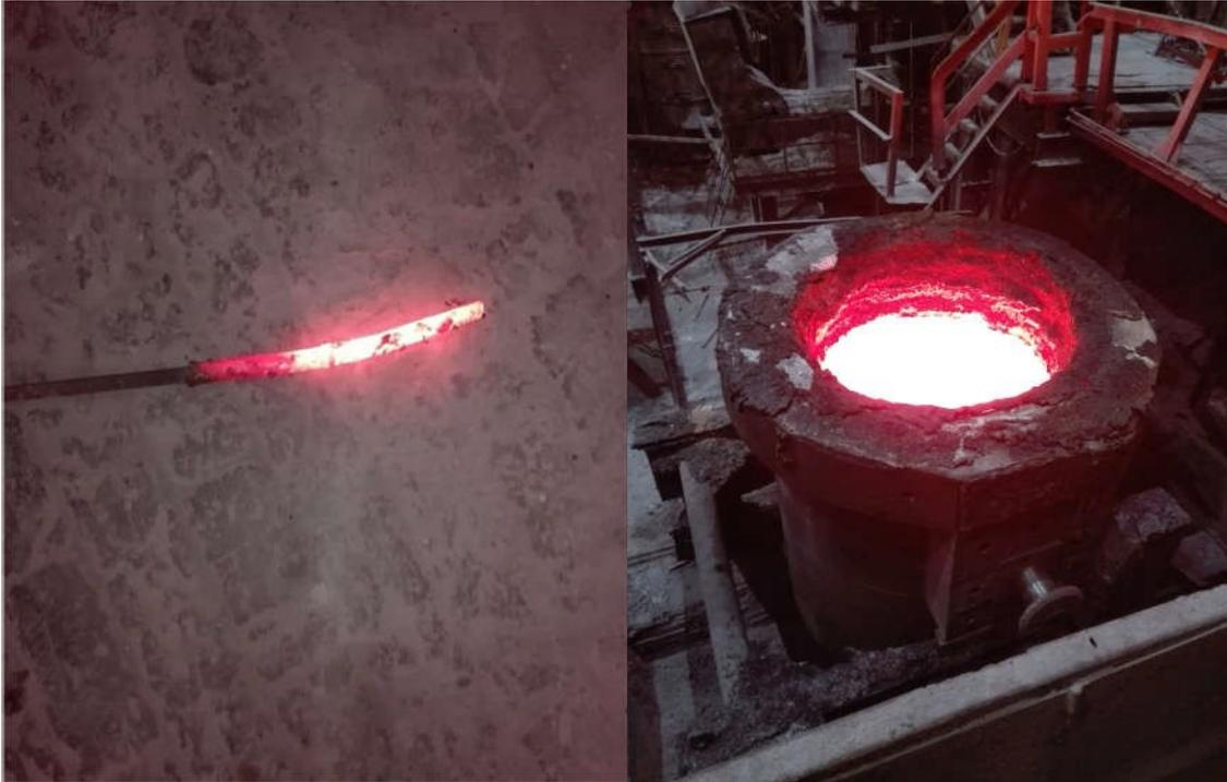
*Figura 2.6. Medición De La Escoria En El Horno Cuchara De Acinox Tunas.*
