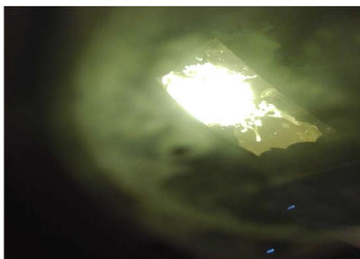
*Figura 2.3. Foto Del Ojo Metálico En Horno Cuchara De Acinox Tunas*
