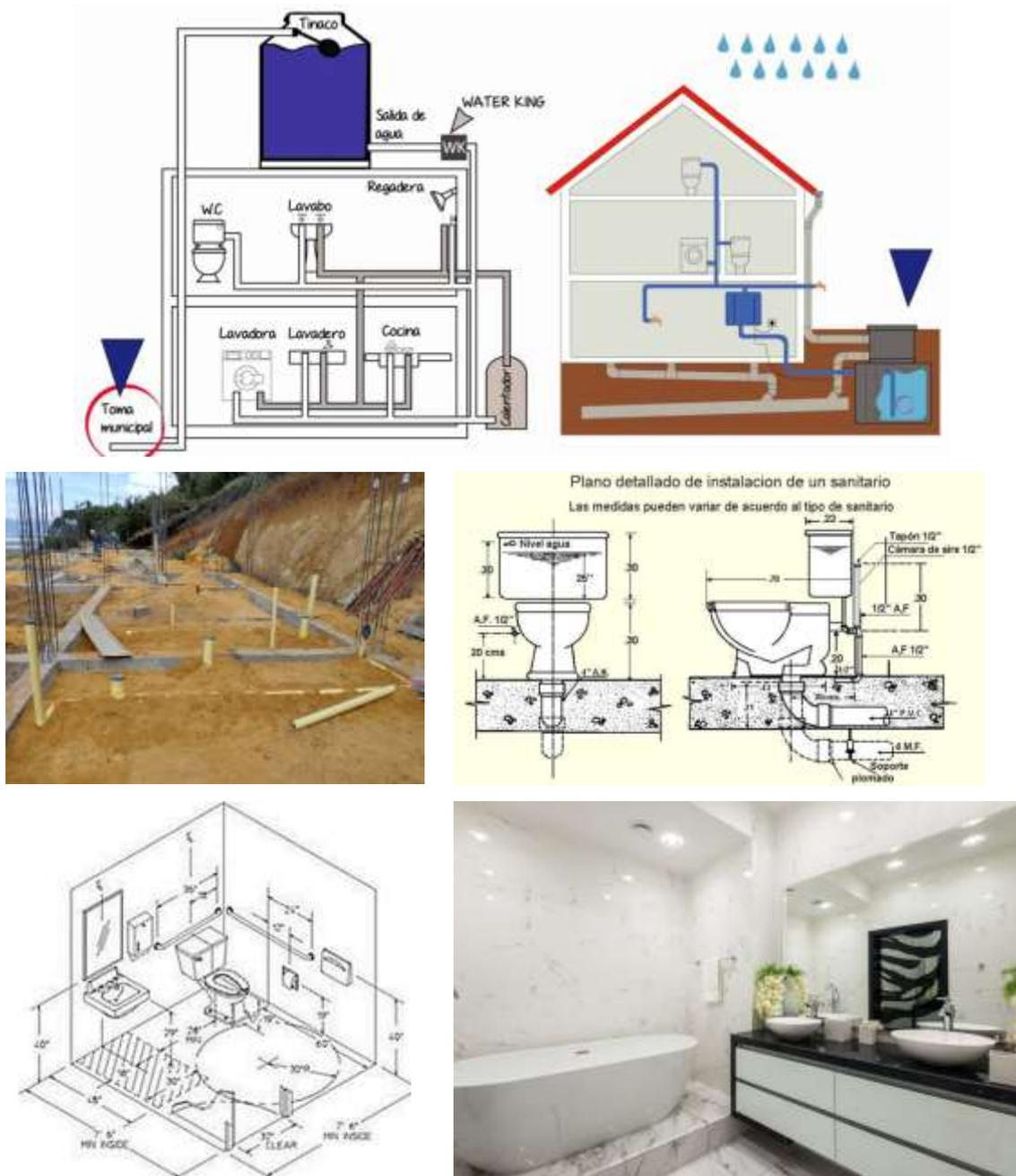
**Figura 1.4** Esquemas generales de sistemas hidrosanitarios en viviendas, (<https://www.homify.com.mx/visitado> en diciembre del 2021 )
