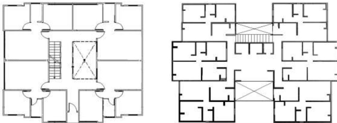
**Figura 2.2.** Características y tipo de planta del sistema FORSA.2017 (Folleto de ingeniería civil 2019)
