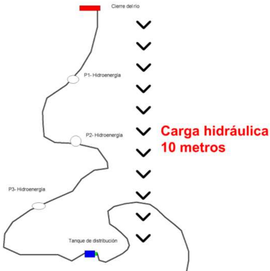
Figura 2.12. Esquema donde se encuentran ubicados los tres puntos de generación de energía eléctrica.
