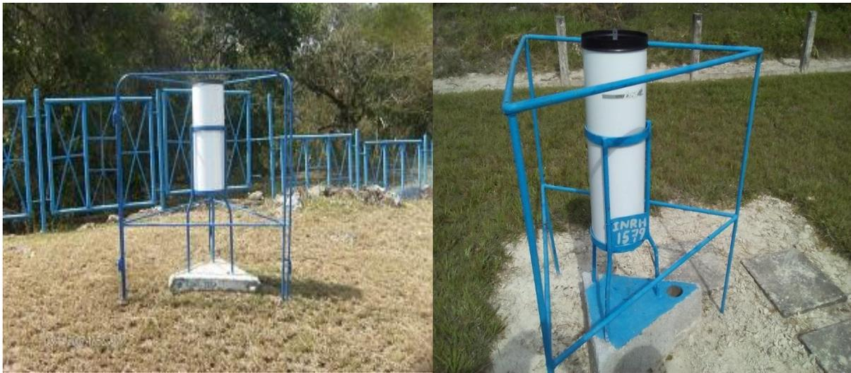
Figura 11-12 Pluviómetros convencionales.
