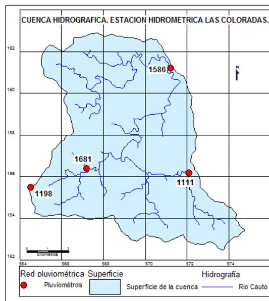
Figura. 19 Hidrografía y Pluviométrica de la estación hidrométrica las Coloradas.
