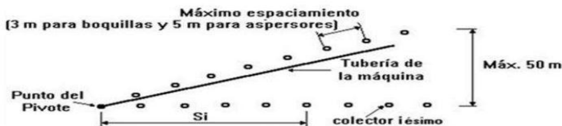
Figura 2.2: Disposición de los colectores para determinar la distribución de agua de las máquinas de riego de pivote central.
