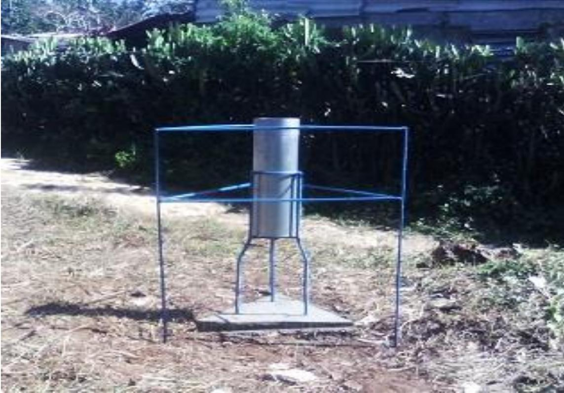
**Figura10.** Equipo pluviómetro.
