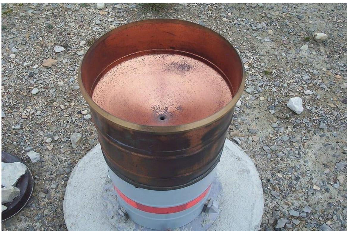
**Figura 12.** Ejemplo de pluviómetro.
