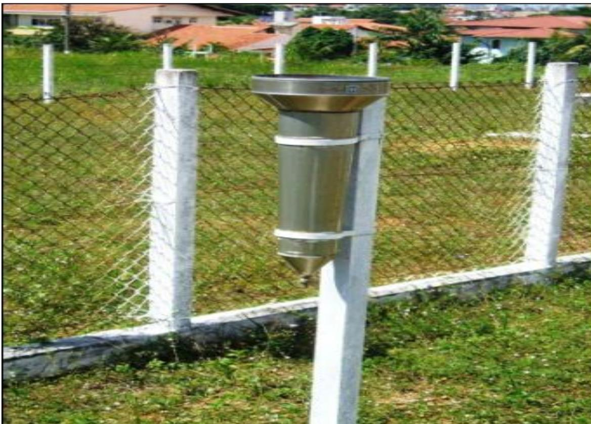
**Figura 14.** Ejemplo de pluviómetro.
