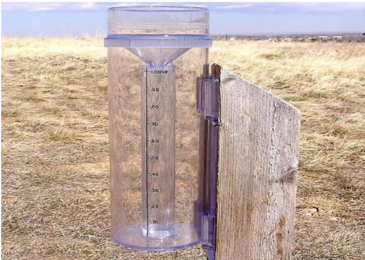
**Figura 13.** Ejemplo de pluviómetro.
