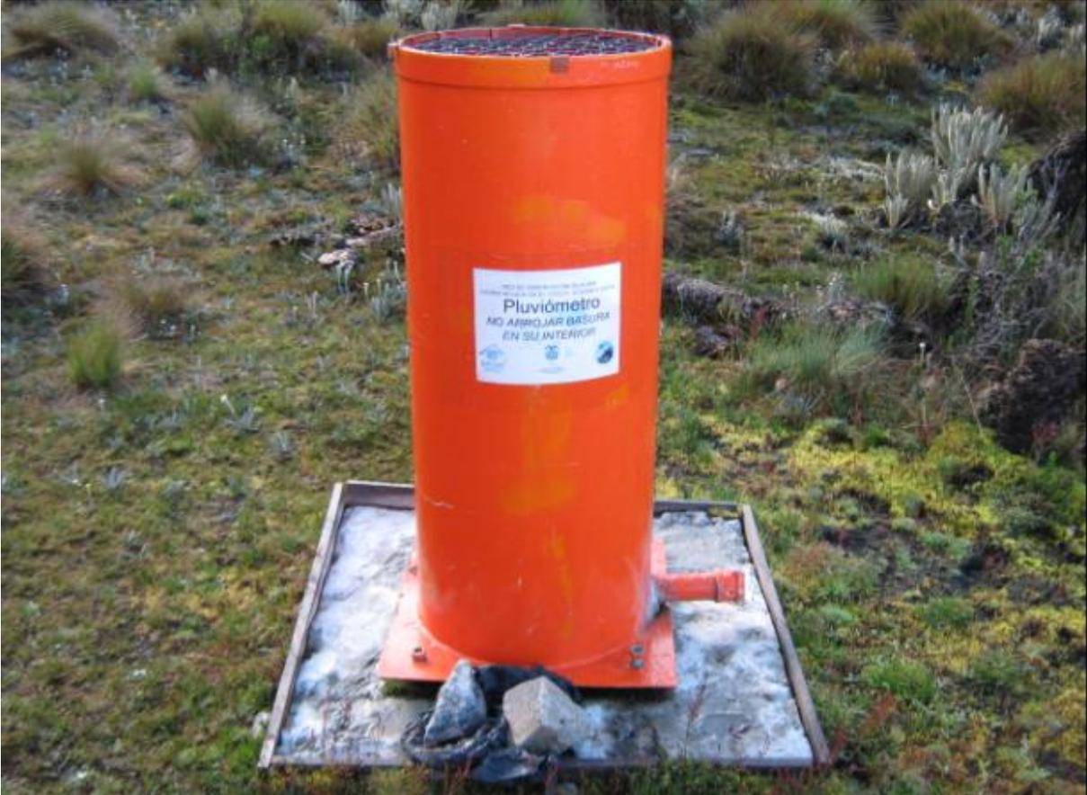
Figura 15. Equipo pluviómetro.
