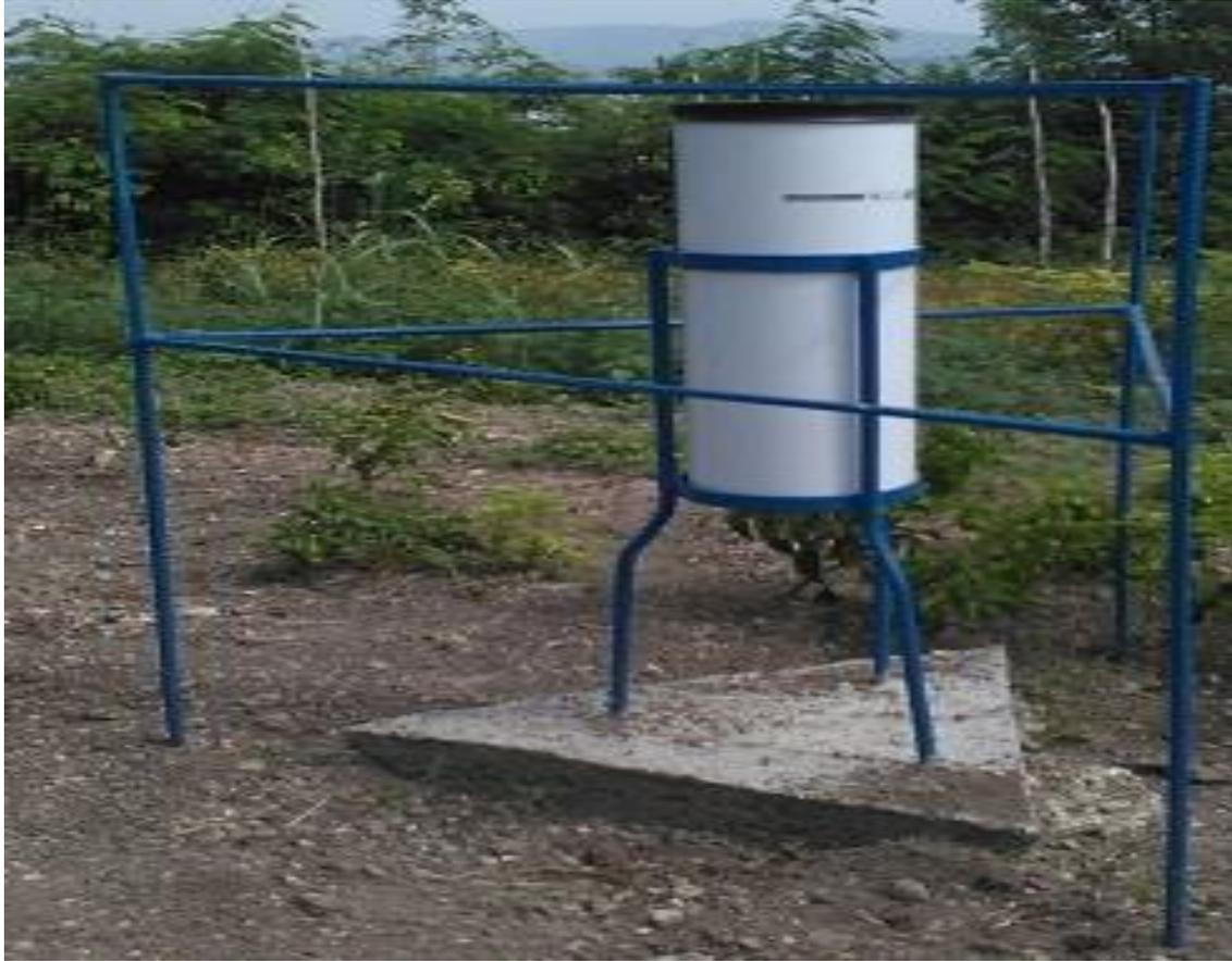
**Figura 19.** Pluviómetro.
