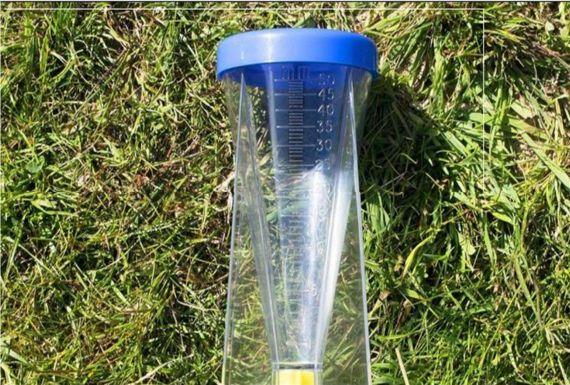
**Figura 11.** Ejemplo de pluviómetro.
