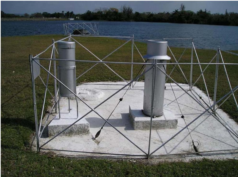
**Figura 8: Pluviómetro y pluviógrafos.**
