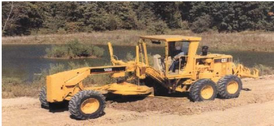
Figura: 8. Motoniveladora. Fuente: Simoneux, (2009).
