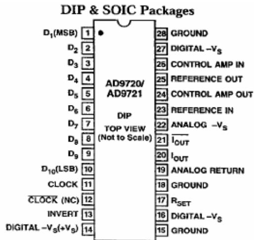
Figura 2.15 Conversor digital / analógico AD9721BN.
