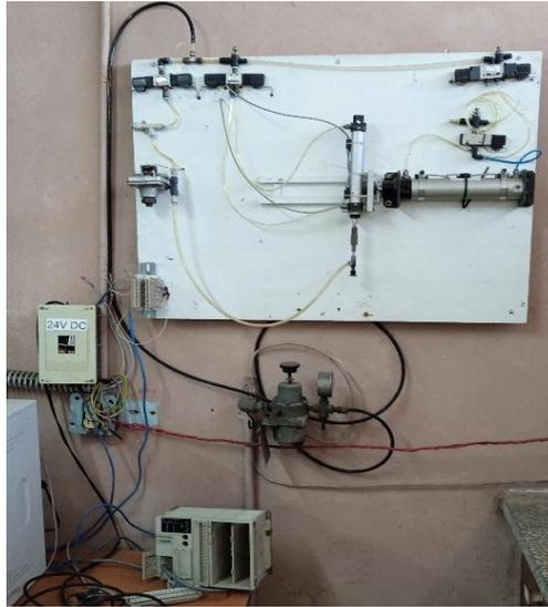
Figura 2 Planta piloto de un manipulador neumático.
