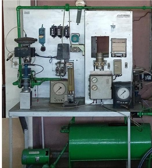
Figura 4 Planta piloto para el control de flujo.
