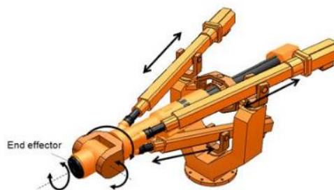
Figura 27. Esquema del modo de cinemática directa
