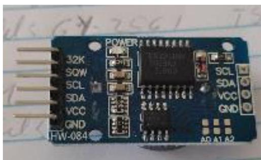
Figura 16. Controlador de Tiempo Real (RTC) DS3231
