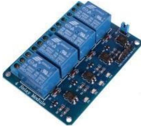
Figura 24. Módulo relé de 4 canales
