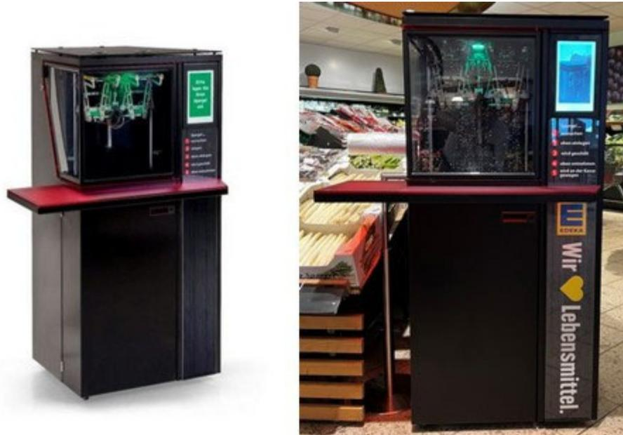
Figura 3. Peladora de espárragos ultra compacta de HEPRO GmbH [18]
