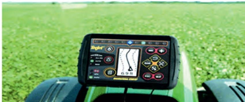
Figura 2. Equipo de conducción autónoma sobre un tractor
