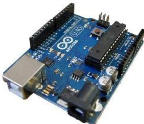
Figura 6. Placa de Arduino Uno R3 [33]
