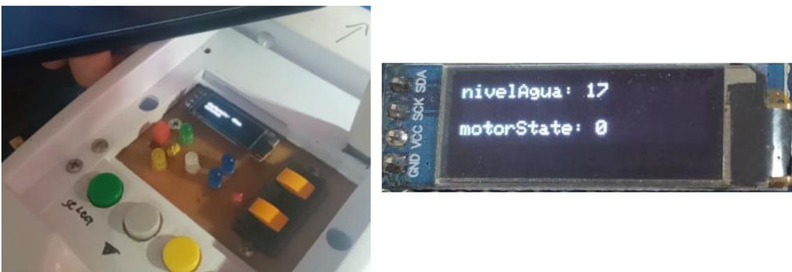
Figura 32. Visualización de datos del controlador Arduino UNO
