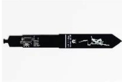
Figura 15. Sensor de humedad Catnip v2.7.8 [44]
