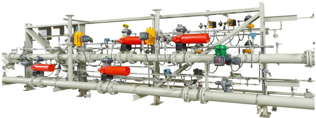
Figura 12. Sistemas de gestión de quemadores (BMS).
