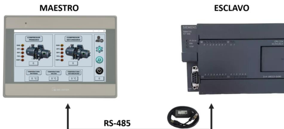
Figura 23. Comunicación entre el HMI y el PLC. Fuente: Autor, 2023.
