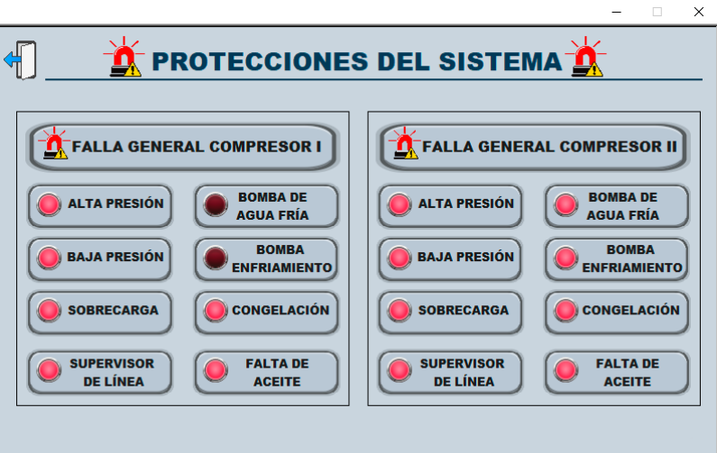
Figura 19. Ventana de protecciones del sistema. Fuente: Autor, 2023. El botón de temperatura permite acceder a la configuración de la temperatura que se desea establecer a la salida del water chiller , en el agua refrigerada (Figura 20).
