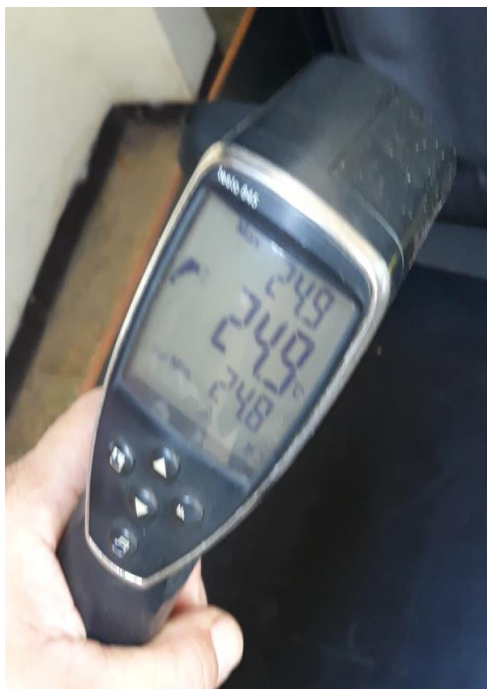
Anexo 2. Instrumento para medir la temperatura Testo 845.
