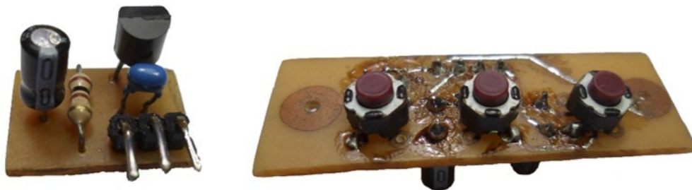
Fig. 3.22. Montaje del teclado y el sensor.
