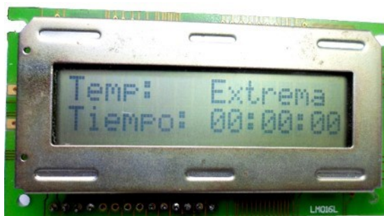
Fig. 3.29. Cartel indicando que el proceso no puede comenzar debido a la temperatura.
